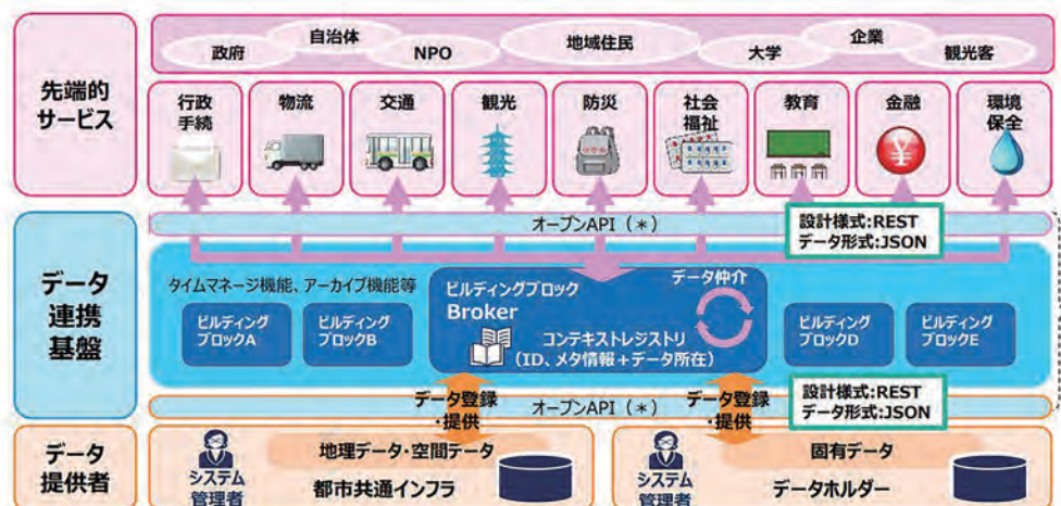
スーパーシティのデータ連携基盤のイメージ。データを集積し、先端的サービスの提供に繋げている(出所:内閣府地方創生推進事務局「スーパーシティ」構想について)
